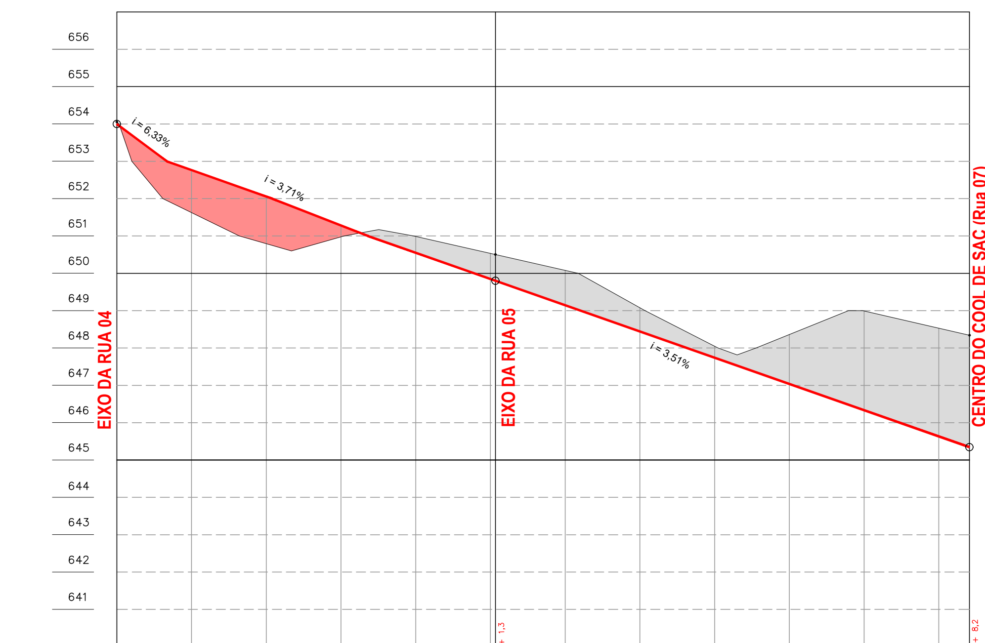
PERFIL LONGITUDINAL DA RUA 07 (trecho 2) ESCALA HORIZONTAL: 1:1000 ESCALA VERTICAL: 1:100 ESTAGUEAMENTO A CADA 20,00 metros
