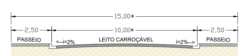
PERFIL TRANSVERSAL RUA 07 (marginal) SEM ESCALA (*) Largura média
