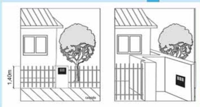
**2) Instalação Lateral:** Para instalação lateral será necessário deixar um recuo no muro ou grade frontal para garantir o acesso ao hidrômetro pela calçada. A largura deste recuo deverá ser no mínimo de 01 (um) metro e ainda permitir a abertura total da tampa.
