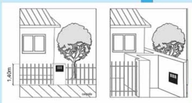
**2) Instalação Lateral:** Para instalação lateral será necessário deixar um recuo no muro ou grade frontal para garantir o acesso ao hidrômetro pela calçada. A largura deste recuo deverá ser no mínimo de 01 (um) metro e ainda permitir a abertura total da tampa.
