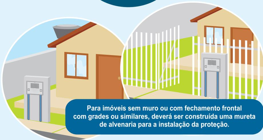
Para imóveis sem muro ou com fechamento frontal com grades ou similares, deverá ser construída uma mureta de alvenaria para a instalação da proteção.
