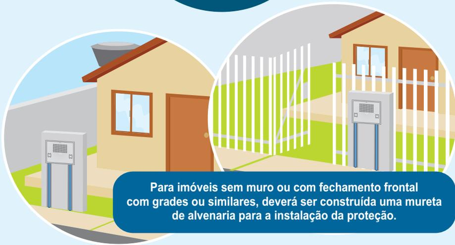
Para imóveis sem muro ou com fechamento frontal com grades ou similares, deverá ser construída uma mureta de alvenaria para a instalação da proteção.
