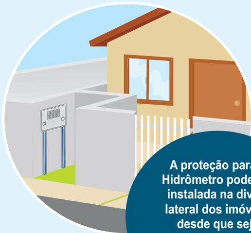
A proteção para o Hidrômetro pode ser instalada na divisa lateral dos imóveis, desde que seja garantido o **LIVRE ACESSO** pela calçada, através de recuo.
