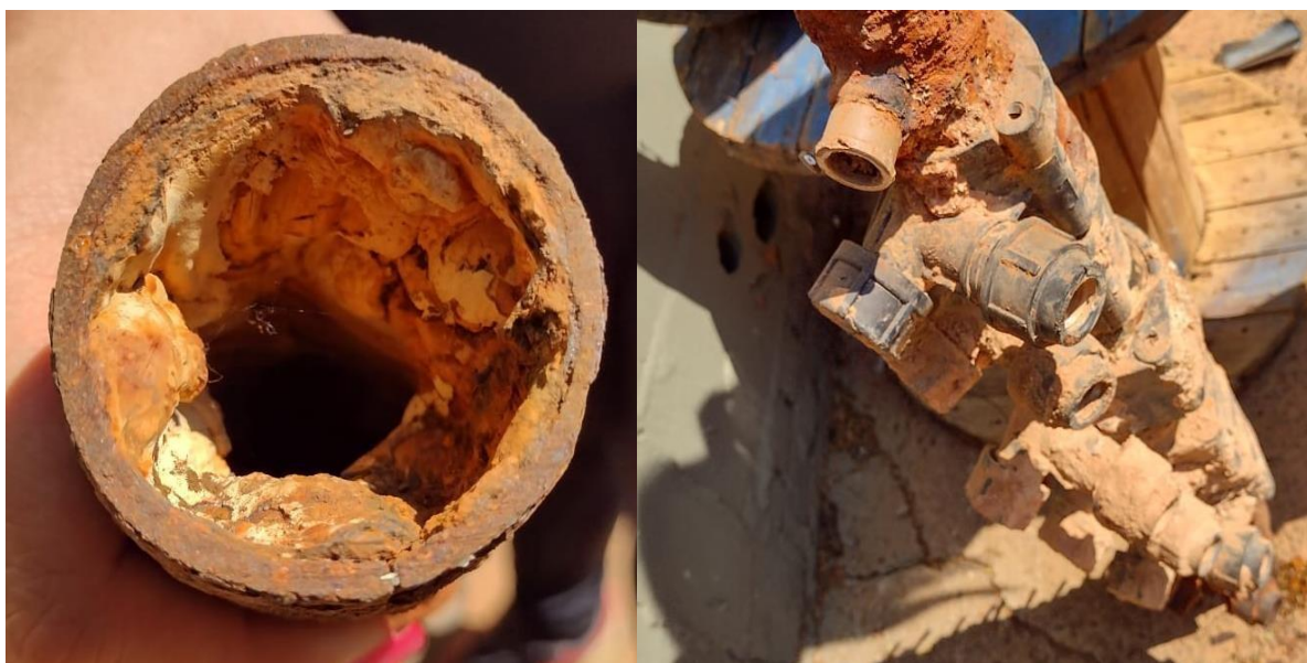
Figura: Fragmentos de rede de distribuição
